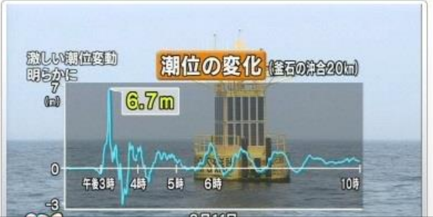
大津波 潮位の激しい変動確認
