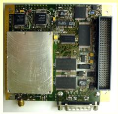
GNSS module CH4701 module
